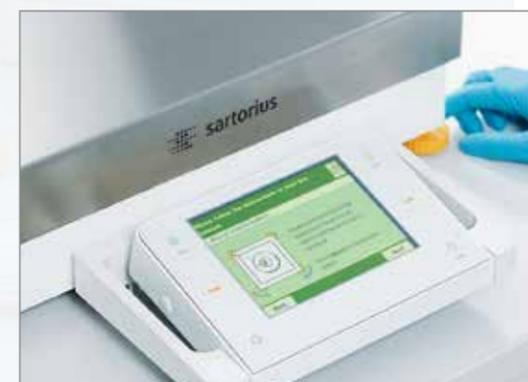
Cubis®连续监控天平的水平状态。利用显示屏上的交互式操作指南，快速进行手动调平。
