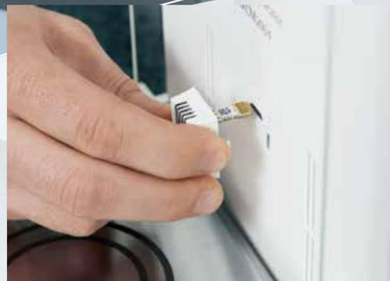
用于温度、湿度和气压的气候传感器集成于一个小巧、紧凑、轻巧的可互换装置内,也可以方便地卸下传感器用于DAkkS校准。
