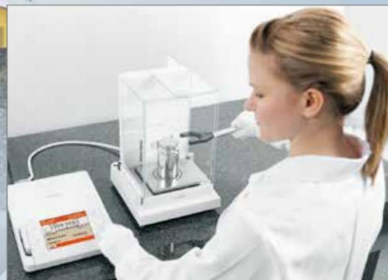
所有Cubis®MCM质量比较仪配有一台独立显示器和控制单元,电子单元与称重单元分离。这样可以降低电子元件和操作人员带来的热影响。
