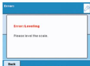
Cubis® 提供警告和提示功能，包含可配置的行动层级用于调平、确定最小样品重量以及校准 | 调整。
