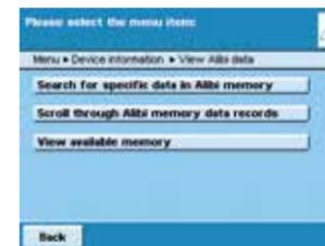
内置式alibi存储器确保将法定贸易称重数据以可追踪方式转移到电脑。
